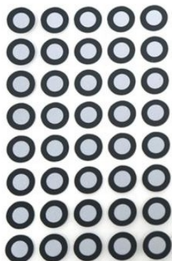
Obrázek 7-6 Značky s vnitřním průměrem 6 mm a vnějším průměrem 10 mm
