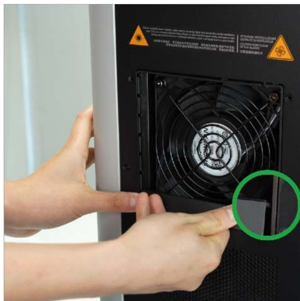
Zacvakněte pravý polohovací blok do drážky
