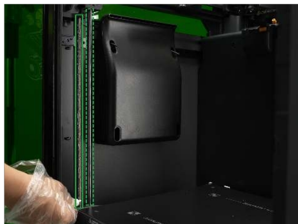
Namažte vodicí šrouby a lineární tyče
