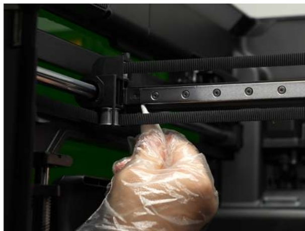
Namažte spodní stranu lineární kolejnice osy X
