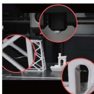
Filament ulpívá na trysce
